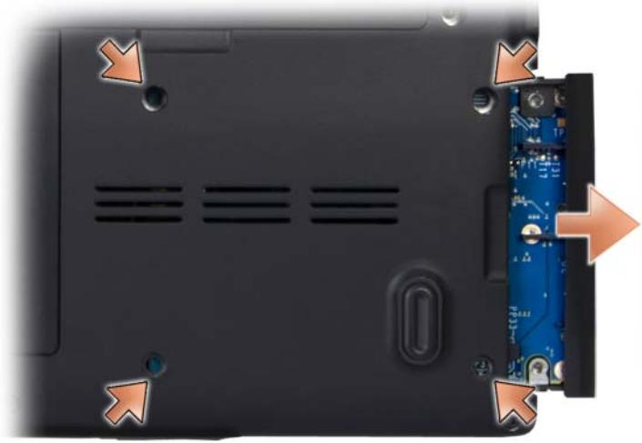
**إشعار:** عند عدم وضع محرك القرص الصلب في الكمبيوتر، قم بتخزينه في عبوة تغليف واقية مضادة للكهرباء الاستاتيكية (انظر "الحماية ضد تفريغ شحنة الكهرباء الاستاتيكية" في دليل معلومات المنتج).
