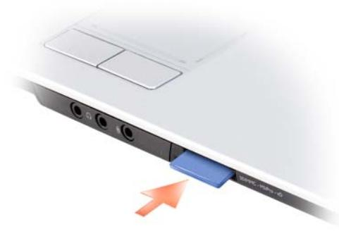
يتعرف الكمبيوتر على بطاقة الذاكرة ويحمل برنامج تشغيل الجهاز الملائم تلقائياً. إذا طلبك برنامج التهيئة بتحميل برامج التشغيل الخاصة بالجهة المصنعة، فاستخدم الوسائط التي ترد مع بطاقة الذاكرة، إن أمكن.
