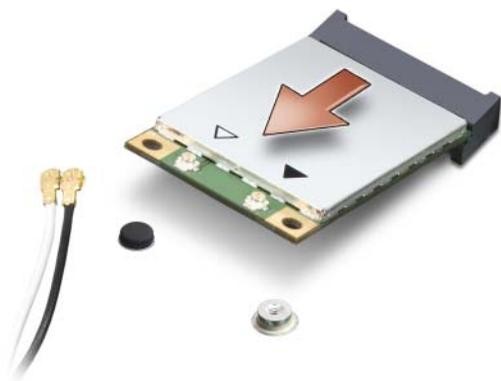
4 قم بتوصيل كابلات الهوائي المناسبة بطاقة WLAN التي تقوم بتثبيتها:
