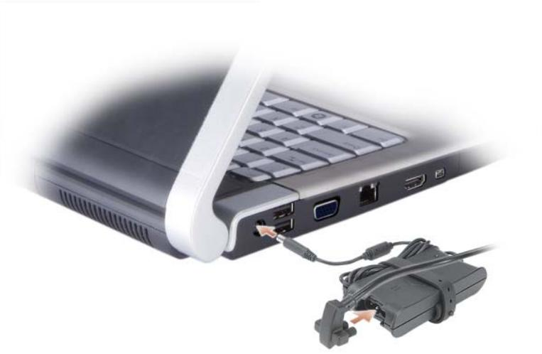
**تنبيه:** يصلح محول التيار المتردد للعمل مع مأخذ التيار الكهربائي في مختلف أنحاء العالم. ومع ذلك، فموصلات وشرايح الطاقة تختلف من دولة إلى أخرى. استخدام كابل غير متوافق أو توصيل الكابل بشريحة طاقة أو مأخذ تيار كهربائي بصورة غير صحيحة قد يؤدي إلى اندلاع حريق أو تلف الأجهزة.
